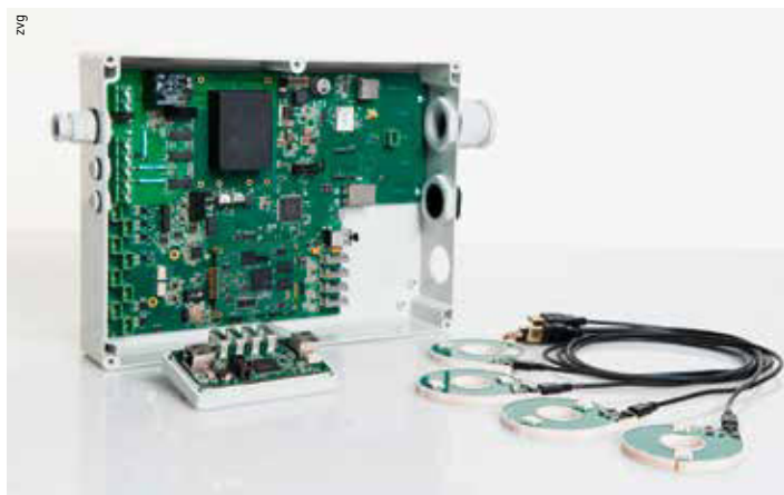
Das GridBox Basismodul, ein Strommodul und vier Stromsensoren.
