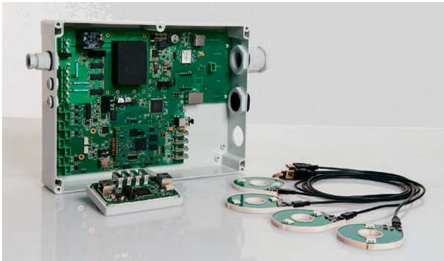
Bild 2 Das Gridbox-Basismodul, ein Strommodul und vier Stromsensoren.
