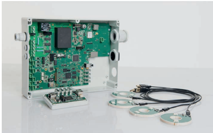
Bild 2. Das Gridbox-Basismodul, ein Strommodul mit vier Stromsensoren
